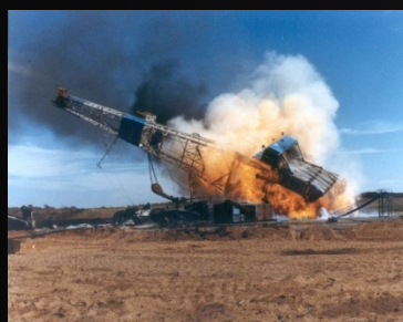
<<<Ein Blowout ist an der Oberfläche oft das einzig sichtbare Verhängnis, welches sich im Erdreich abspielt“>>>
